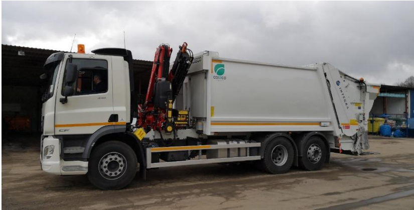
Zdjęcie 12. Śmieciarka jednokomorowa z żurawiem HDS
